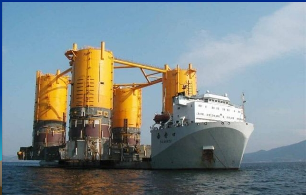
中远航运“泰安口”号20000吨级半潜船运输海上钻井平台构件，该构件重达7000吨以上。
