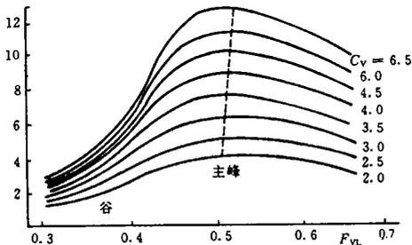
圆艏快艇的剩余阻力系数  $C_R$  的影响不明显。在主峰区域当  $C_v$  大于 4 时,峰值将急剧增加。高速双体船就是利用快艇的这种特性,把单体分成两个片体后,使  $C_v$  系数减少一半,而剩余阻力系数  $C_R$  也下降 50% 以上。因此大多数高速双体船有利的  $F_{vL} = 0.8 \sim 0.9$ ,  $C_v = 1.69 \sim 2.5$  之间,恰好落在快艇的上限,滑行艇的下限区域,亦即处于向滑行过渡的阶段,其摩擦阻力与剩余阻力相当接近,并利用向尾部过渡的尖艏方尾滑行面提供的水动力来减少浸湿面积。
