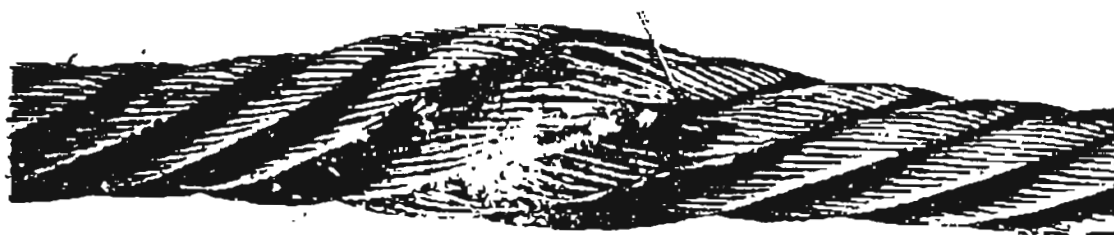
图 E. 18 部分被压扁:是由于局部被压裂造成绳股间不平衡加之断丝而引起的——应报废
