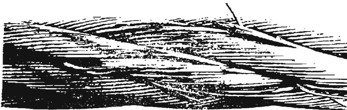
图 E.1 交互捻钢丝绳两相邻绳股中的断丝及钢丝的位移——应报废
