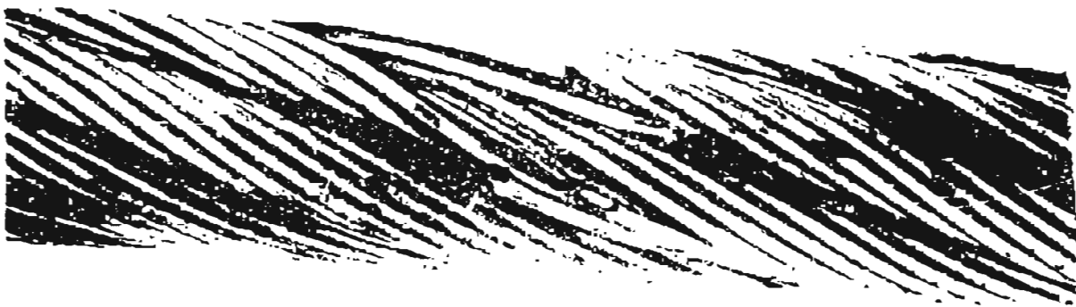
图 E.3 同向捻钢丝绳在一股中有断丝,并伴随着轻度的磨损——如果这种情况代表着最严重的缺陷,应继续使用(但断丝应剪去断开端,使钢丝的尾部处在绳股空隙之中,这样就可防止进一步损伤相邻的钢丝)
