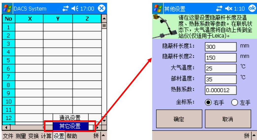
大气温度、部材温度根据是现场实际情况进行设置，需注意的是正确的温度设置能有效提高测量精度。坐标系我们是选用右手坐标系。
