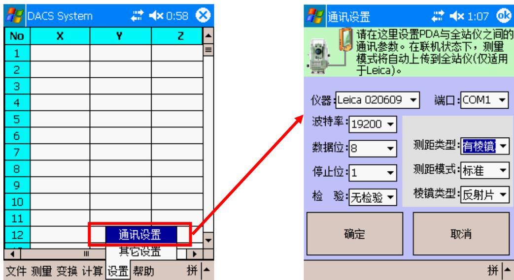
仪器为全站仪类型，波特率、数据位、停止位、检验和全站仪设置统一。EDM 类型、模式、棱镜类型根据实际情况选择并和全站仪统一。
