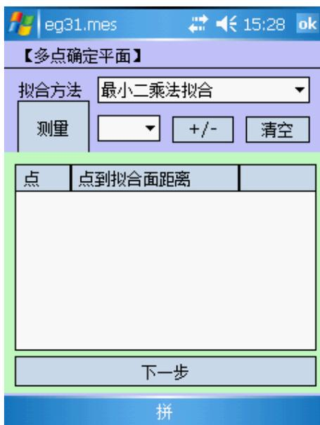
先选择拟合方法，然后点击测量按钮，会根据测量的多个点确定一个平面。平面的法向正向以测量的前三个点的逆时针右手拇指方向为正。测量平面时的点坐标记录在文件“文件名+定面.mes”命名的文件中。
