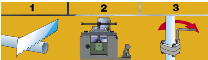
PARKER 扩口法兰连接：1.截管；2. 管口机械成型；3. 安装
