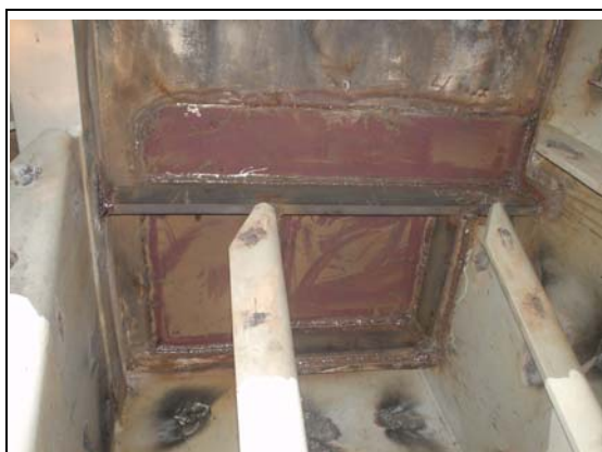
图 5 勘察机舱位置损坏甲板下构件
