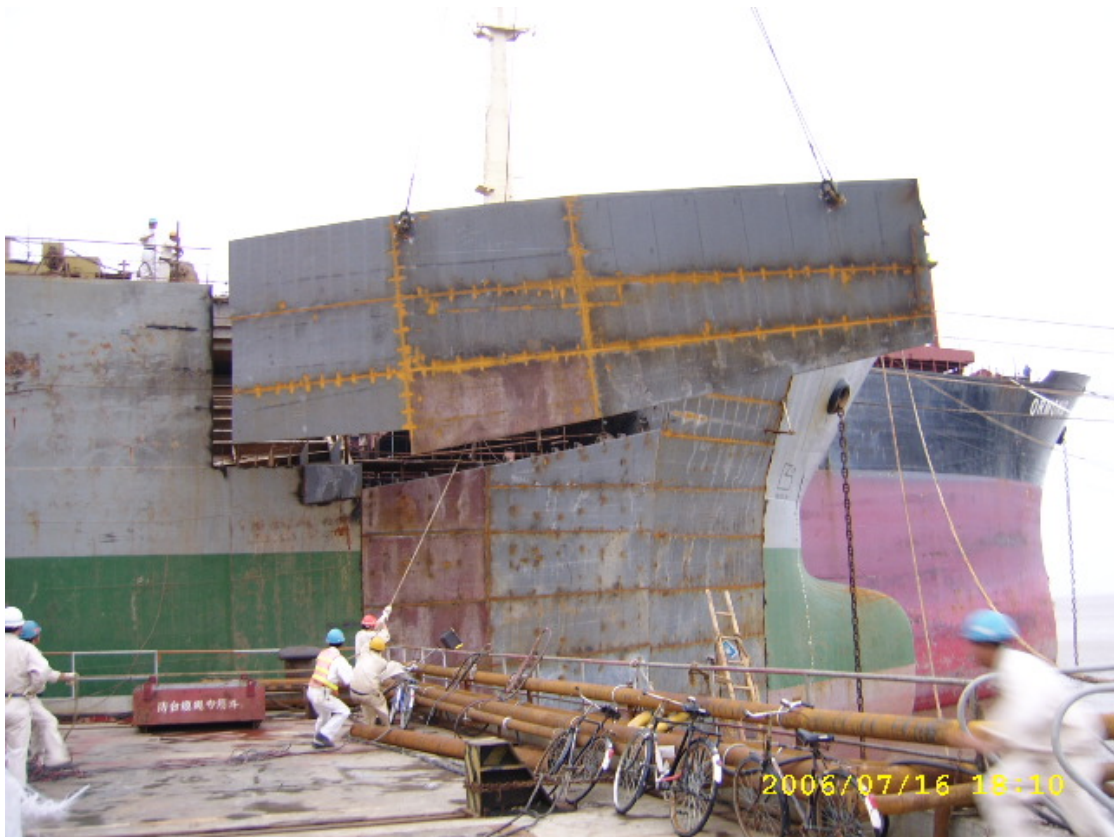
最后安装顶边舱分段
