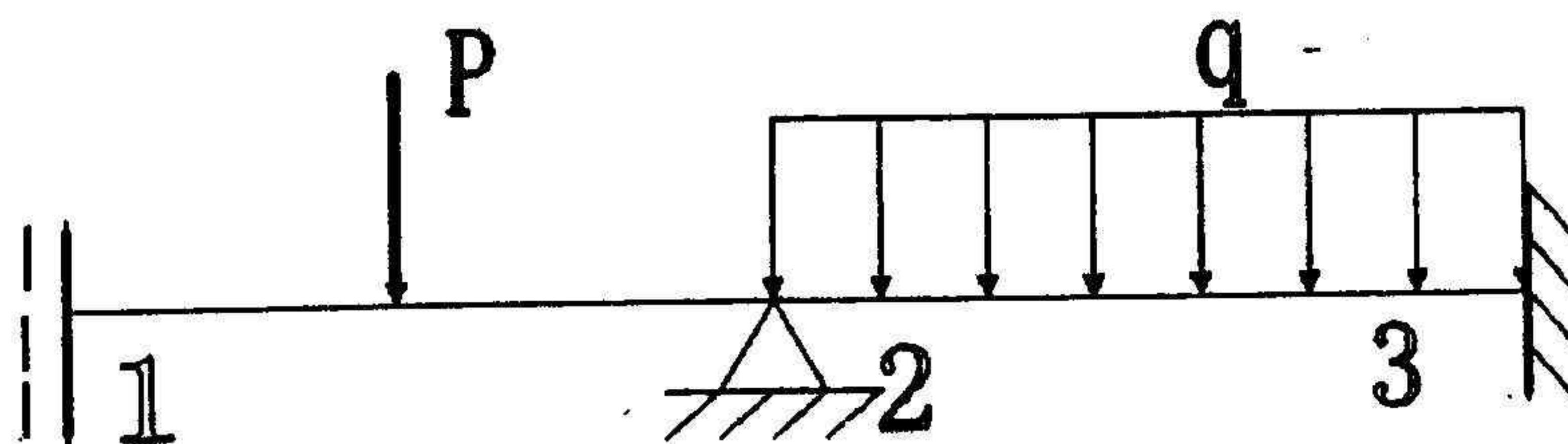
五. (25) 用矩阵位移法求解该梁，列出总体刚度矩阵并进行约束处理。
