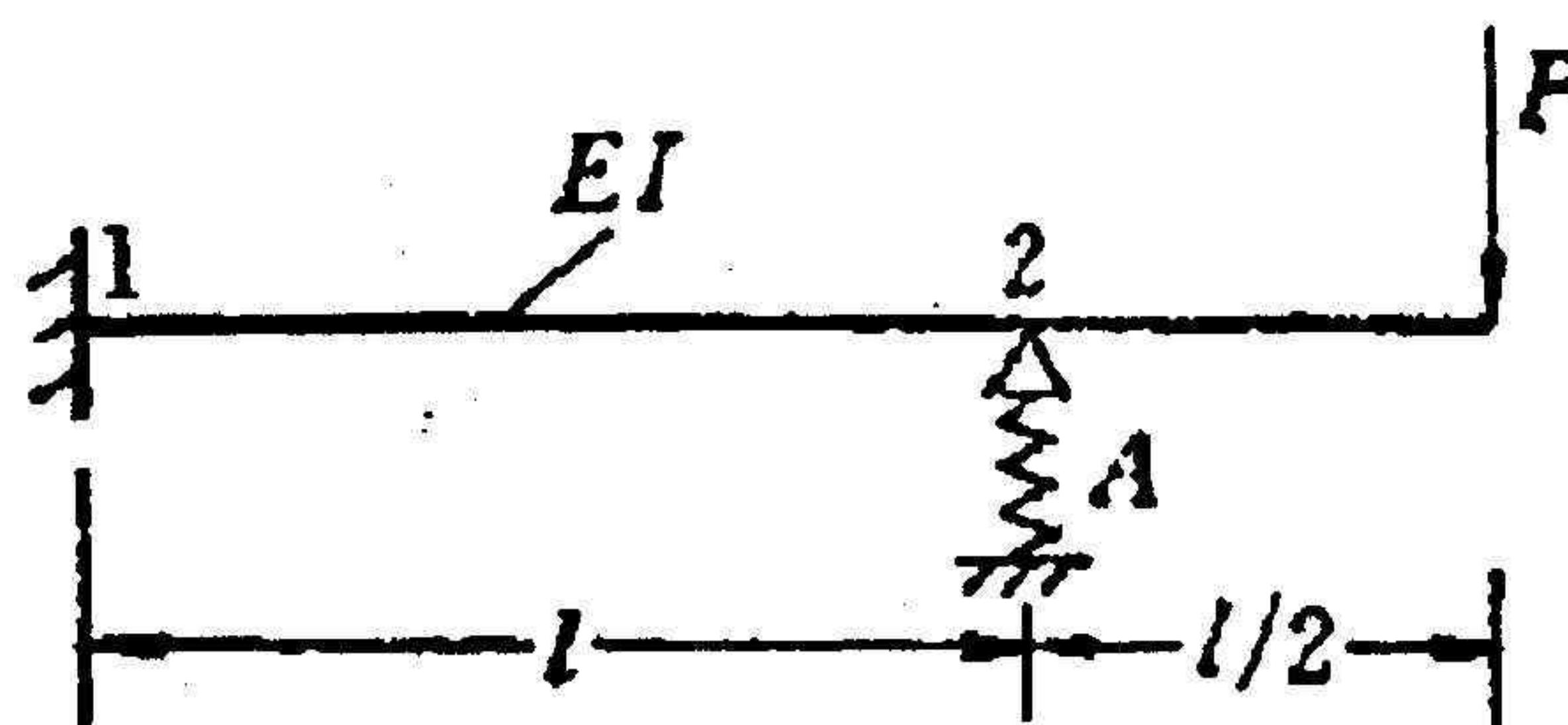
四. (25) 求解下图连续梁的静不定问题。已知:
